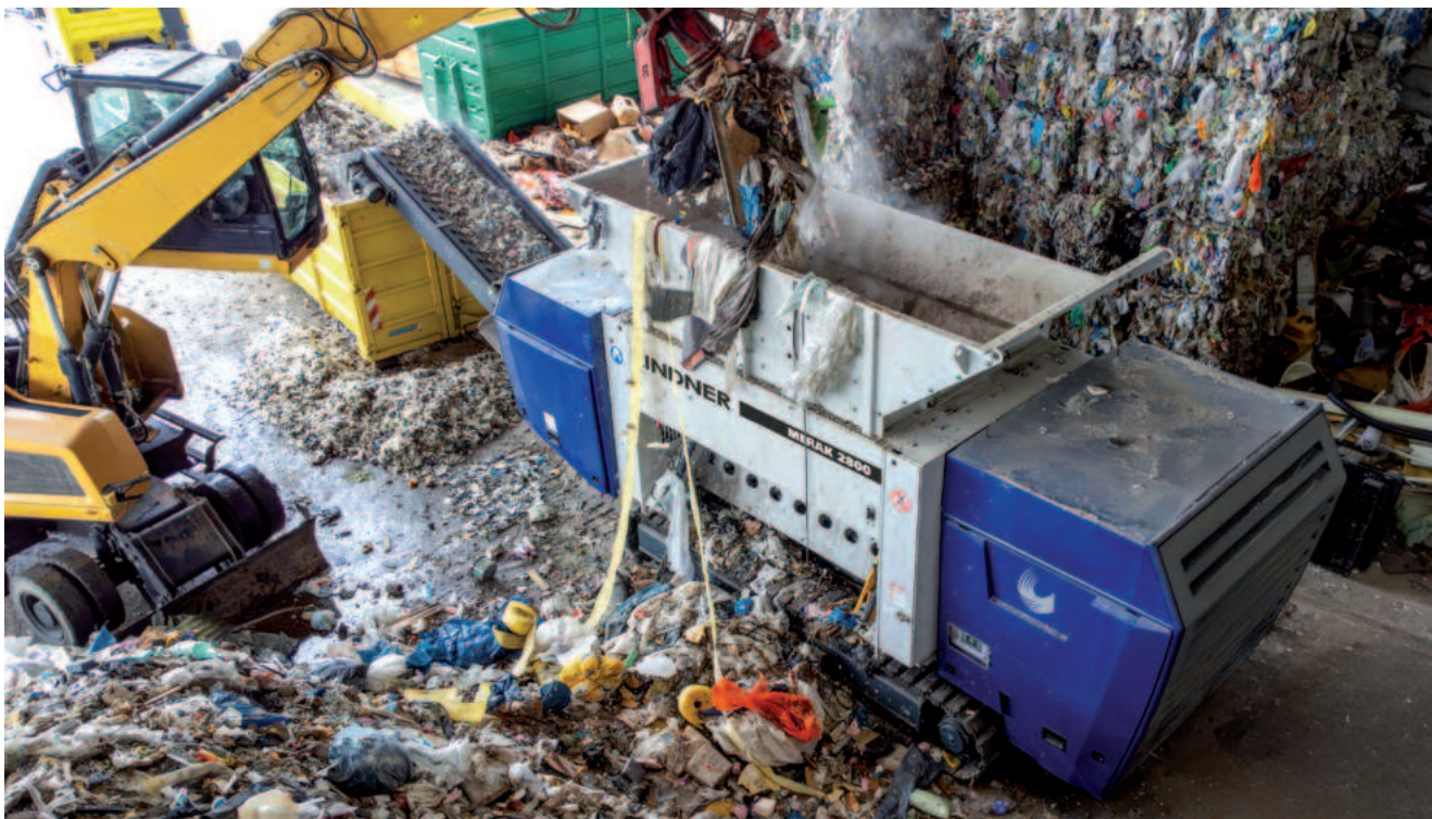
Der Merak 2800 ist ein leistungsstarker Universalzerkleinerer für ein breites Spektrum unterschiedlichster Materialien und ermöglicht – je nach Anwendung und Siebkonfiguration – definierte Outputgrößen im Bereich von 30 bis 120 mm. Auf der IFAT präsentiert Lindner den etablierten Schredder mit einem neuen Antriebskonzept, der den Einsatzbereich wesentlich erweitert (Bilder: Lindner)
