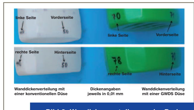
Bild 2: Wanddickenverteilungen im Bodenbereich (Quetschnahtbereich) einer Verpackungsfläche, die mit einer konventionellen konischen Düse und mit einer in erster Näherung zylindrischen GWDS-Düse erreicht wurden
