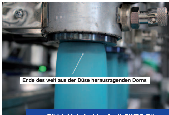
Bild 1: Mehrfachkopf mit GWDS Düsen, wobei das profilierte Dornende weit aus der Düse herausgefahren ist, so dass die Profilierung nicht wirksam ist
